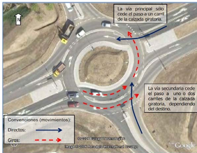
Fig.4.10. Turboglorieta básica en Rotterdam (Holanda). Lenin Alexander Bulla. 3
