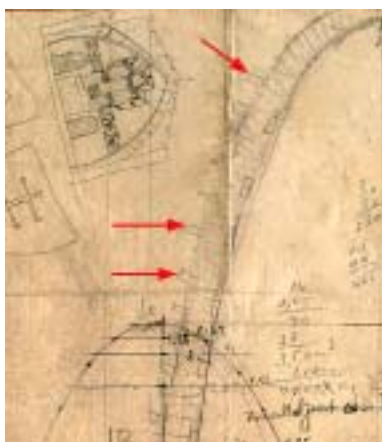
DG-183e. Detalle de dovelas en uno de los arcos parabólicos, 1918.
