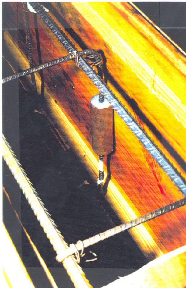
Foto 9.- Detalle de la instrumentación de la armadura longitudinal. Las galgas pegadas a la armadura fueron protegidas mediante un tubo metálico hueco para evitar que el rozamiento con el hormigón o el aumento de temperatura durante el fraguado pudiera dañarlas.
