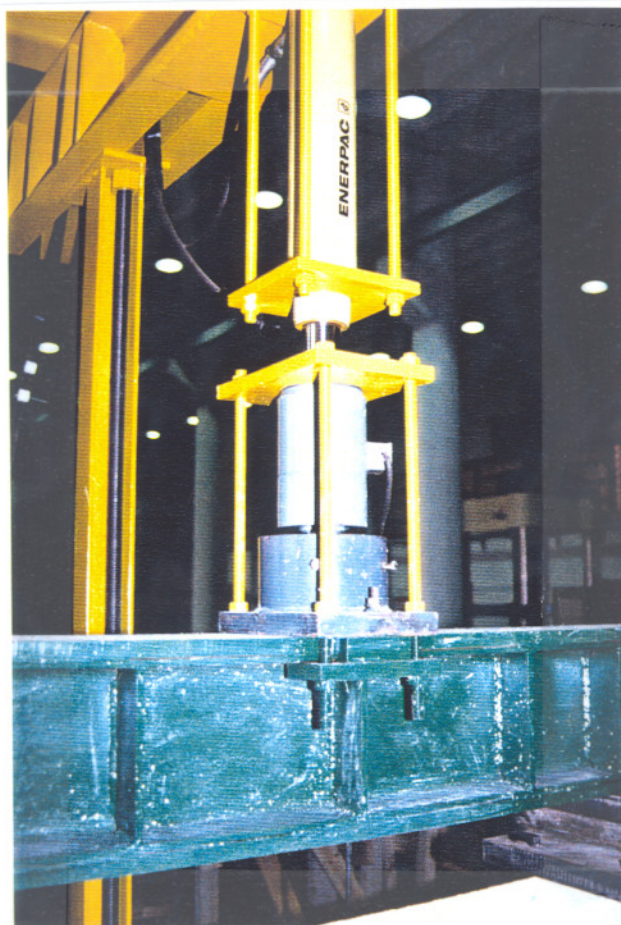
Foto 21.- El equipo de carga utilizado en los ensayos de rotura estaba formado por un pórtico metálico doble, anclado a la losa de carga, y dotado de un gato hidráulico de doble acción que permitió colgar de él la viga de reparto.
