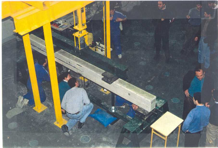
Foto 23.- Después de cada incremento de carga se procedía a la visualización y marcado de fisuras. Ello permitió croquizar, posteriormente, el estado de fisuración de las vigas.
