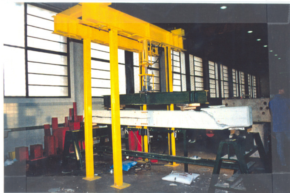
Foto 32.- Vista general del estado final de la viga C22. En las vigas sometidas a precarga el plano de rotura fue más evidente que en el caso de las ensayadas justo después del descimbrado.
