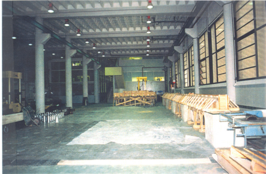
Foto 1.- Vista general del laboratorio. Disposición de los encofrados de las vigas y los moldes para probetas.
