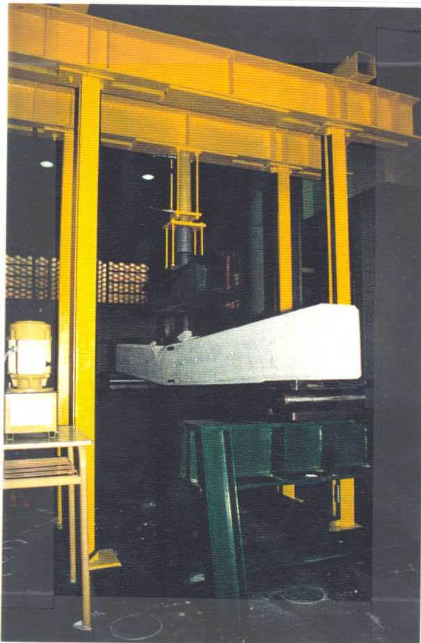
Foto 23.- Después de cada incremento de carga se procedía a la visualización y marcado de fisuras. Ello permitió croquizar, posteriormente, el estado de fisuración de las vigas.
