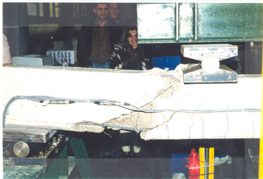
Foto 30.- Detalle de la rotura de la viga R21. La grieta de cortante se iniciaba junto a la rótula superior, con una inclinación entre 35^\circ y 45^\circ .
