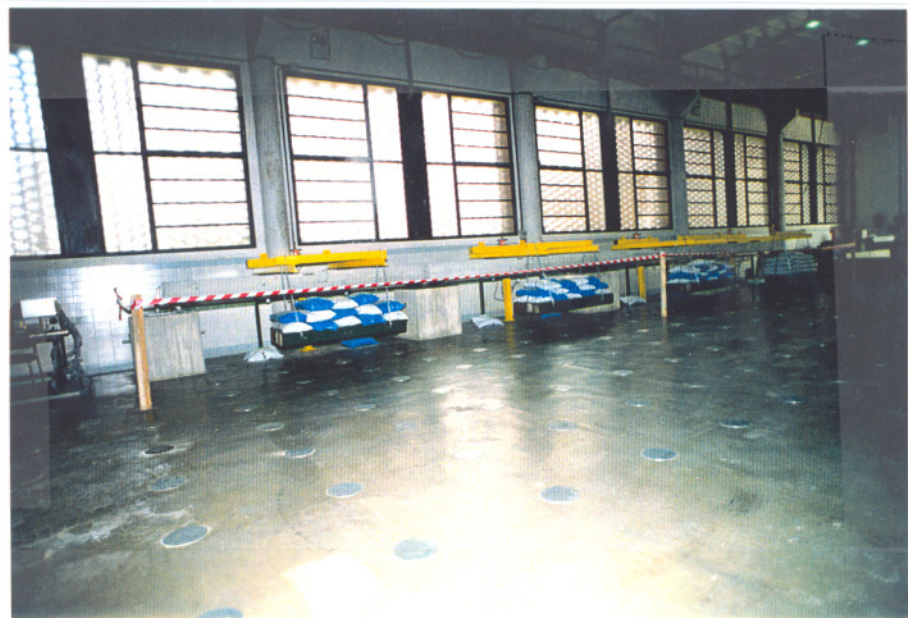
Foto 36.- Vista general de las cuatro vigas de la segunda serie sometidas a carga mantenida (ensayo de fluencia).
