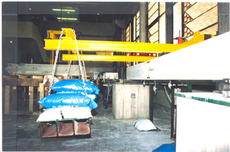
Foto 12.- La medición de flechas en los ensayos de fluencia se realizó mediante relojes comparadores. Éstos estaban sujetos a un pequeño pórtico metálico que se apoyaba en la losa de carga y era inmovilizado con sacos de arena.
