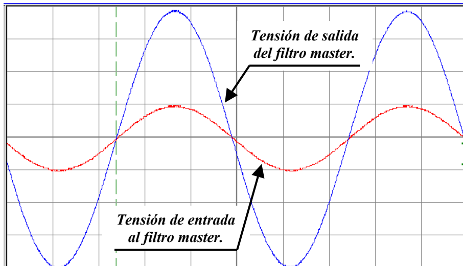
Fig. 5.15.- Señales experimentales de entrada y salida al filtro master cuando el filtro está sintonizado a una frecuencia de 10 kHz y un factor de calidad igual a 8. Escala para la señal de entrada de 100 mV/div para la salida de 200 mV/div. Eje de tiempo: 20 \mu s/div.
