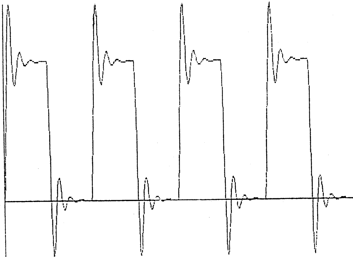
Figura 2.28 Tensión de salida del convertidor buck con un ciclo de trabajo de evolución cuadrada, con tiempo de muestreo de 1 \mu s.
