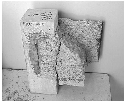
Fig. B31 En esta foto también se puede observar la cantidad de hormigón desgarrado junto con la lámina que se desprendió de la superficie de la probeta.
