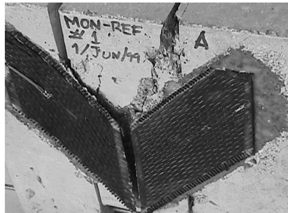
Fig. B6 En esta foto se puede apreciar como la falla se presentó más rápidamente por el lado derecho al prolongarse más rápidamente la fisura y por lo tanto el desprendimiento de la lámina con la galga 2 la cual está en el mismo lado derecho solo que al otro lado de la probeta.
