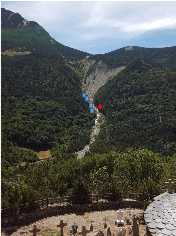
Figura 21 Localización de los geófonos (recuadros azules) y de la cámara de video (círculo rojo) instalados (Fuente propia)
