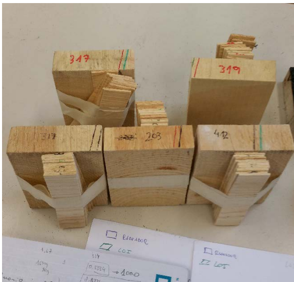
Ilustración 29: Muestras cortadas en tiras preparadas para realización del L.O.I.; Fuente: Elaboración propia
