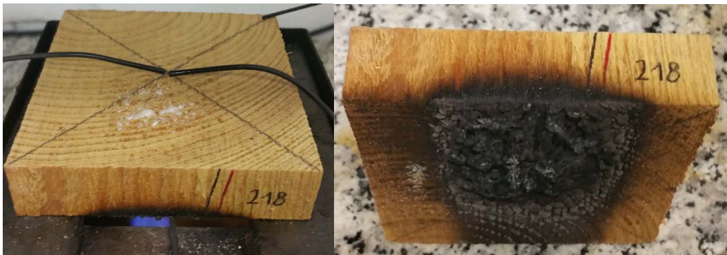
Ilustración 45: Muestra 218 P.Laricio (App) en ensayo del bunsen y después de realizarlo; Fuente: Elaboración propia
