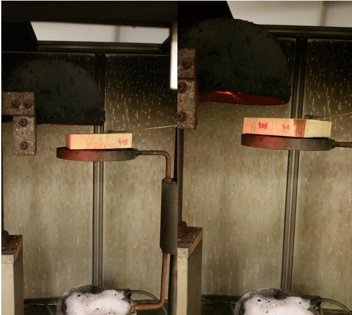
Ilustración 27: Ensayo de goteo en el radiador; Fuente: Elaboración propia
