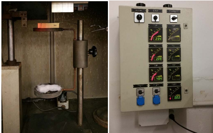
Ilustración 25: Ensayo de goteo en laboratorio del fuego EPSEB; Fuente: Elaboración propia
