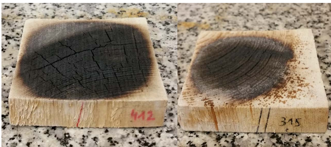
Ilustración 28: Muestras ensayadas en el ensayo de goteo; Fuente: Elaboración propia
