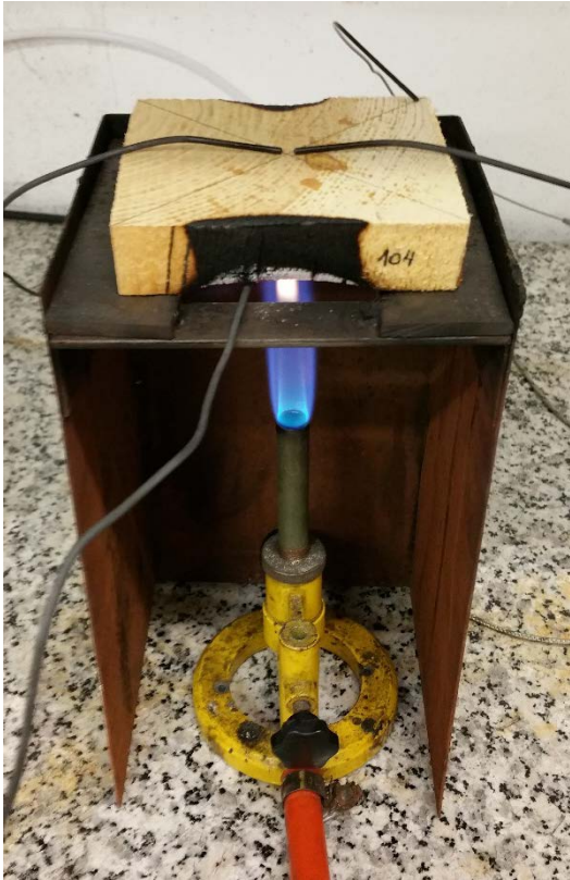
Ilustración 34: Ensayo de llama directa con Bunsen; Fuente: Elaboración propia
