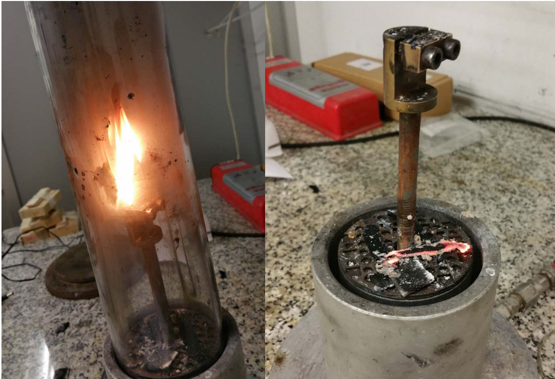
Ilustración 40: Ensayo positivo de L.O.I. con combustión total de la muestra; Fuente: Elaboración propia
