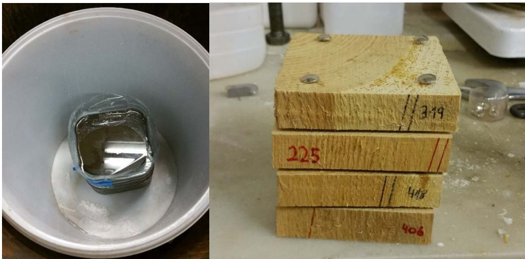
Ilustración 22: Impregnación con polifosfato de amonio FR CROS 134; Fuente: Elaboración propia
