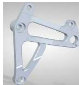
Ilustración 50 Cuerpo del estribo izquierdo
