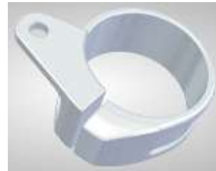
Ilustración 49 Sujeción amortiguador de dirección
