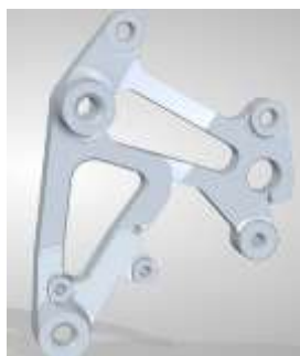
Ilustración 54 Estribo derecho por la parte interna
