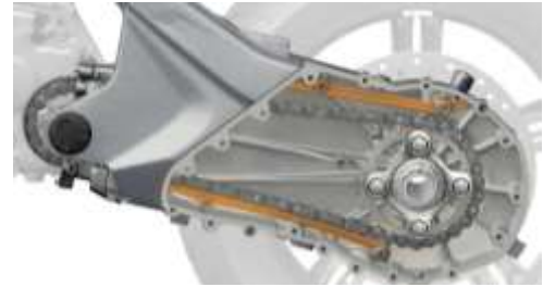
Ilustración 18 Basculante con eje coaxial de una BMW-C-650
