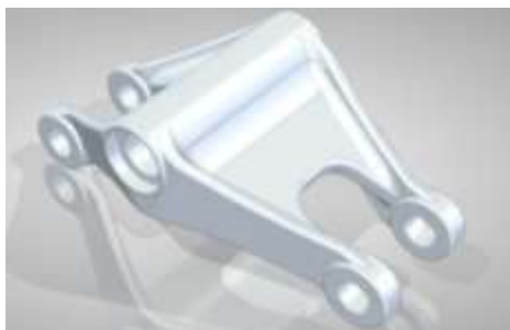
Ilustración 31 Triángulo de la suspensión acabado
