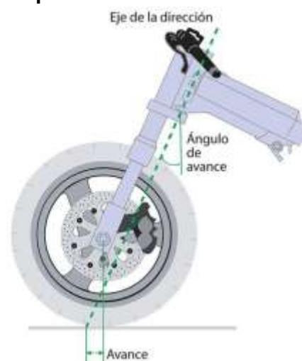
Ilustración 13 Medidas de la suspensión delantera
