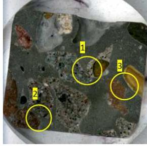
**Figura 1. Zonas de interés en la muestra de concreto permeable.**
