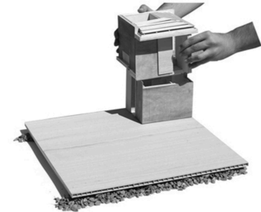
4. El refugi 'riu' ve muntat de taller en dues parts únicament. In situ s'acobben d'unir els dos elements, que s'apilen un sobre de l'altre.
