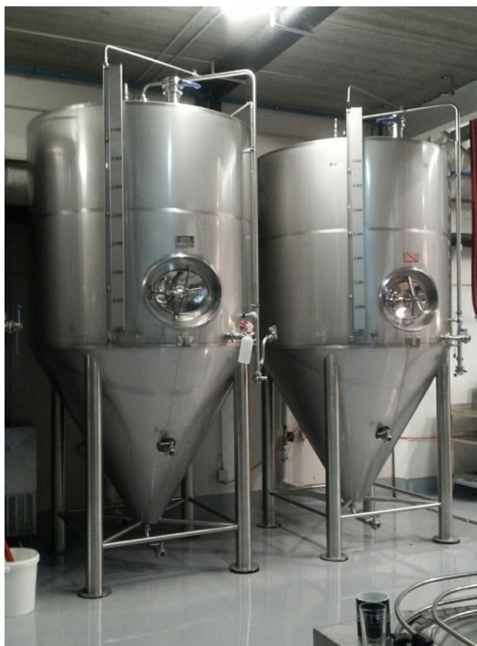
Figura 50. Fermentadores cilindrocónicos isobáricos. Fuente: http://ingenieriacervecera.weebly.com/
