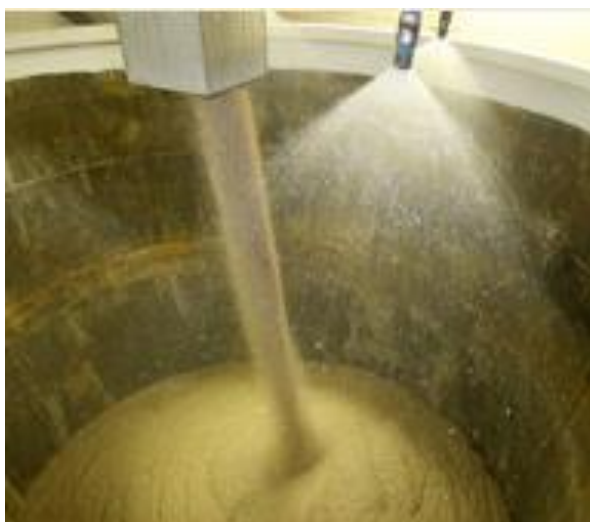
Figura 16. Inicio del proceso de malteado en el que se mezcla agua con cebada en el tanque de remojo. Fuente: http://www.briess.com
