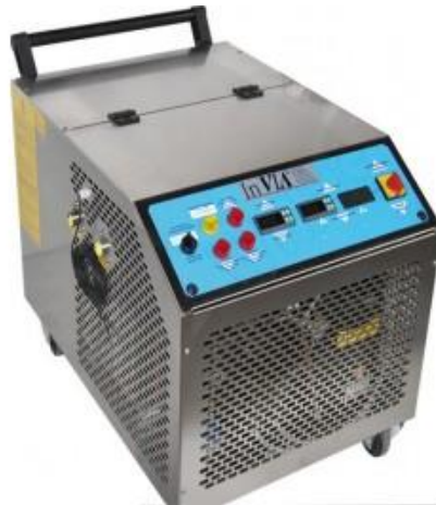
Figura 51. Equipo de frío/calor para controlar la temperatura de los depósitos cilindrocónicos. Fuente: http://www.tiendainvia.com/
