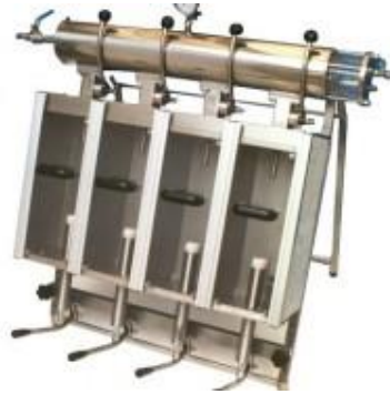
Figura 52. Llenadora de botellas isobárica. Fuente: http://www.decavi.com/
