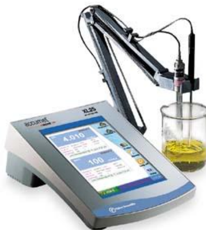
Figura 56. Medición del pH mediante un pH-metro. Fuente: http://www.ehu.eus/
