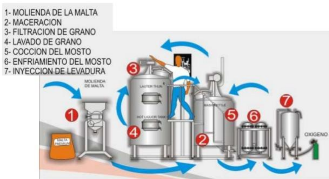
Figura 20. Diagrama de flujo del proceso completo de fabricación del mosto. Fuente: http://beertec.galeon.com/
