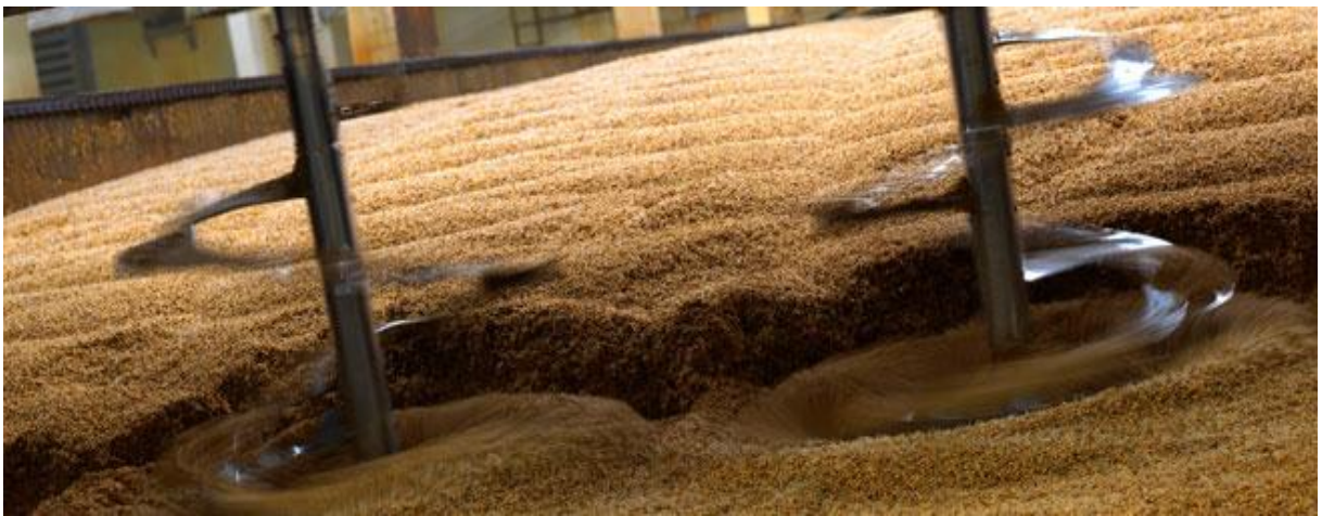
Figura 18. Detalle de los tornillos sinfín removiendo los granos de cebada germinada. Fuente: http://www.crispmalt.co
