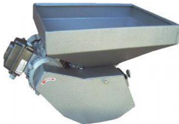
Figura 25. Molino de dos rodillos con una producción de 200 kg/h. Fuente: http://micro-cervecerías.cervezartesana.es/
