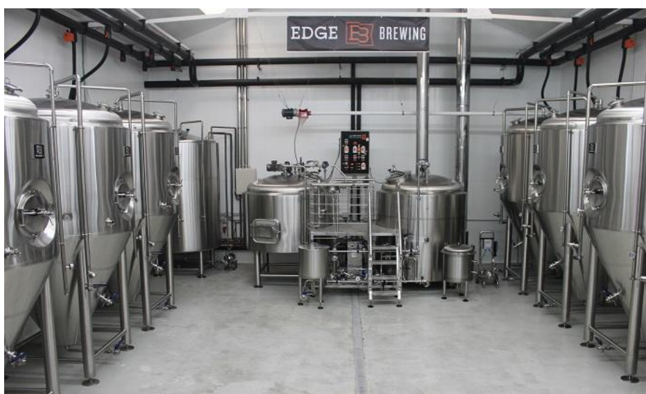
Figura 3. Imagen de una pequeña fábrica de cervezas actual con todos los depósitos de acero inoxidable. Fuente: http://edgebrewing.com/
