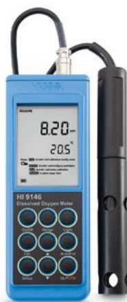
Figura 57. Instrumento para la medida de oxígeno disuelto en la elaboración de cerveza. Fuente: www.hannainst.com .
