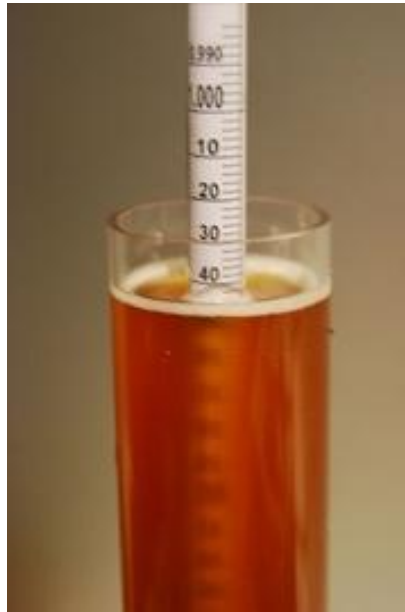
Figura 55. Medida de la densidad con un densímetro. Fuente: http://brewmasters.com.mx/
