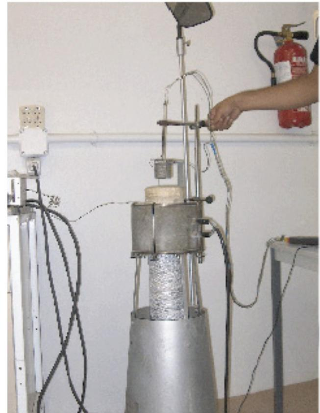
Figura 2. Horno utilizado para ensayar el comportamiento a altas temperaturas de probetas de concreto
