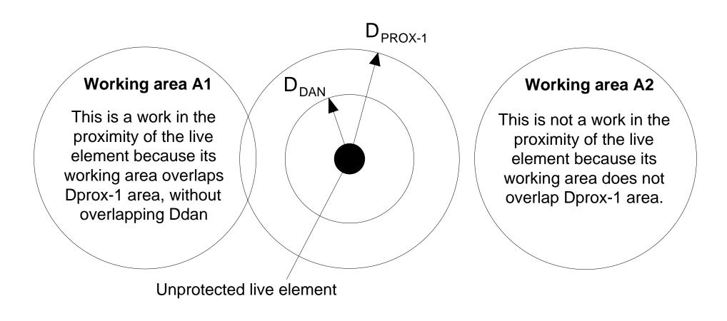
**Figure 4.** Activities for which the work area can be precisely defined. Source: *Guía técnica para la evaluación y prevención del riesgo eléctrico*.
