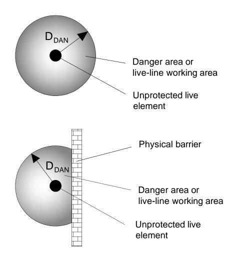
**Figure 3.** Hazardous area for live work with and without a physical barrier. Source: *Guía técnica* para la evaluación y prevención del riesgo eléctrico.
