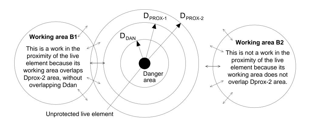
**Figure 5.** Activities for which the work area cannot be precisely defined. Source: *Guía técnica para la evaluación y prevención del riesgo eléctrico.*
