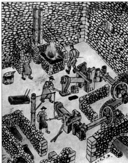
Representació gràfica del funcionament d'una farga, segons J. Mateo.
