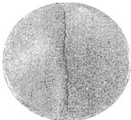
Fig. 3. Aspecto de la fractura durante el ensayo de compresión diametral.
