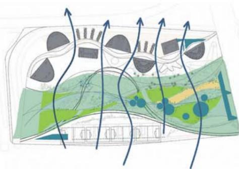
Sistema de climatización pasivo mediante franja adiabática con vegetación y láminas de agua abundante proporcionando un cojín térmico. Las brisas marinas en una parcela expuesta totalmente frente al mar puede ser un sistema eficaz de confort térmico. En las épocas calurosas, cuando la tierra está más caliente que el mar se produce una subida del aire terrestre que hace que el aire más templado del mar se dirija a tierra.
