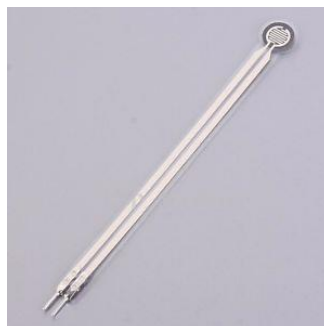
Figura 4.6 Sensor de força per resistència RFP 602. [Centenary Materials, www.ebay.com]
