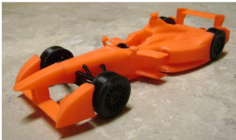
Figura 2.18 Model Fórmula E, monoplaça de molt alt rendiment de propulsió 100% elèctrica. En aquest cas s'hauria de modificar la escala un 20% més petita per a no interferir en el factor de bloqueig. [www.thingiverse.com]
