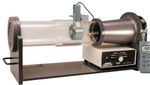
Figura 7.3 Mini túnel aerodinàmic Omega WTM-1000. [www.omega.es]
