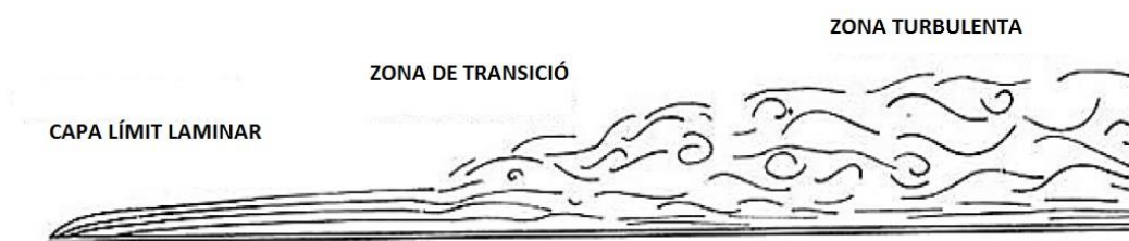
Figura 1.6 Representació del comportament del flux en les diferents zones. [4]
