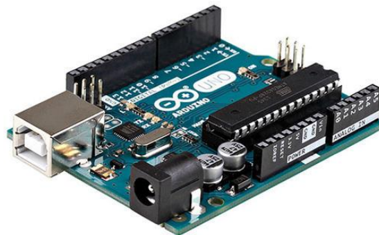
Figura 4.11 Placa Arduino Uno. [www.arduino.org]
