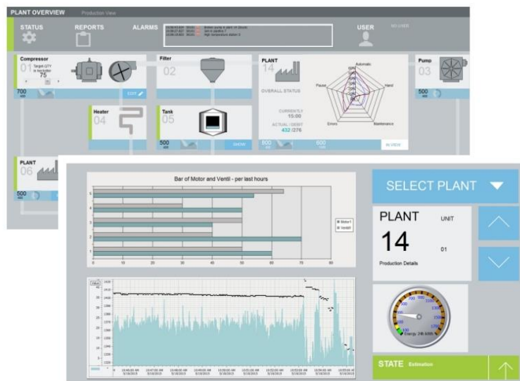
Figura 6.2. Exemple d'SCADA SIMATIC WinCC de Siemens
