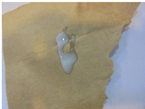
Figura 6. Mercancía afectada por agua de mar (Test de Cloruros)Fuente: Propia.
