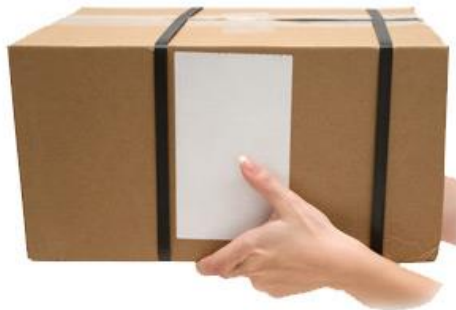
Figura 5. Ejemplo de trincaje mediante flejes de plástico en cajas de cartón corrugado. Fuente: Embamat.
