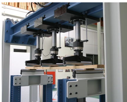
Fig. 5-4 Banco de ensayo a flexión con varios actuadores
