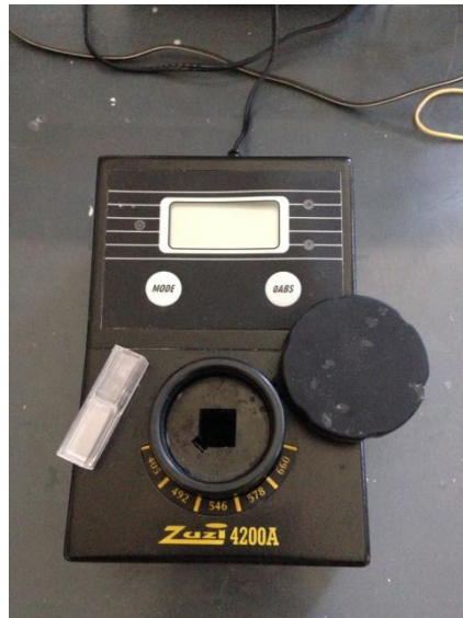
Figura 20. Espectrofotòmetre de taula utilitzat per determinar la terbolesa de la dissolució
