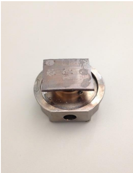
Figura 23. Placa metàl·lica amb les mostres equimolars a diferents temperatures al 10 % i al 20%
