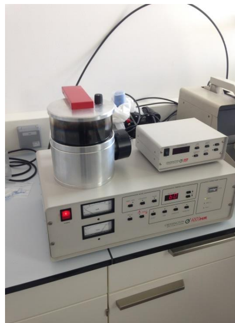
Figura 24. Aparell per cobrir la mostra d'un aliatge metàl·lic
