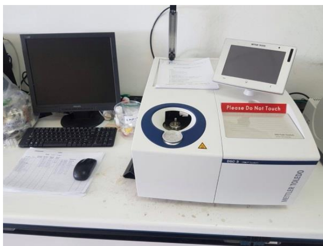
Figura 22. Aparell emprat per realitzar una calorimetria diferencial d'escombrat
