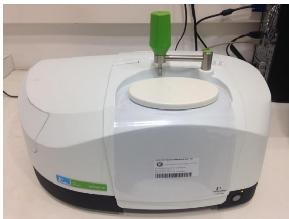
Figura 21. Espectroscopi d'infraroig utilitzat en la caracterització
