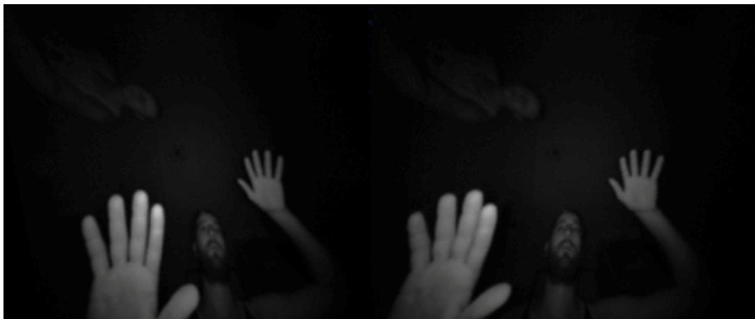
Figura 26 Imatge de les càmeres del Leap Motion
