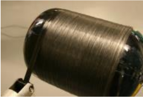
Il·lustració 6.5 Bobinat d'un dipòsit
