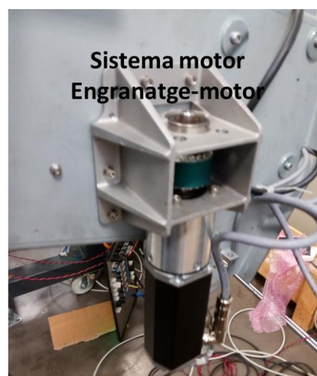
Figura 21: Prototip del tensor amb problemes de vibracions mecàniques
