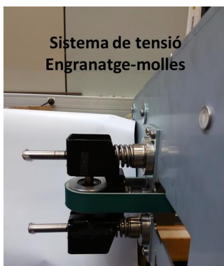
Figura 21: Prototip del tensor amb problemes de vibracions mecàniques
