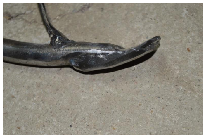
21: Suport del radiador d'aigua reparat i soldat de nou (Font: Foto pròpia)
