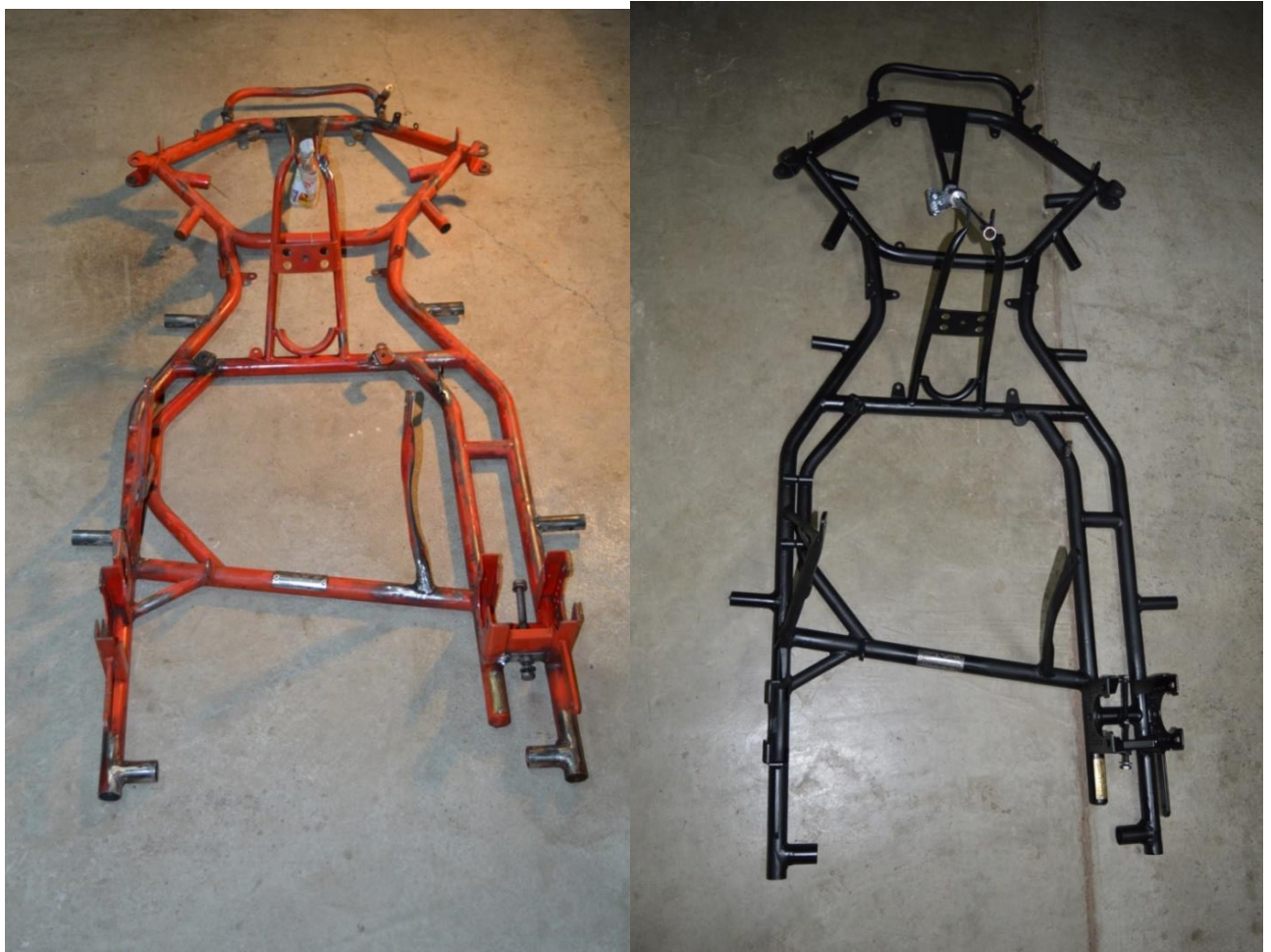
16: Xassís abans i després de reparar, polir i pintar (Font: Foto pròpia)
