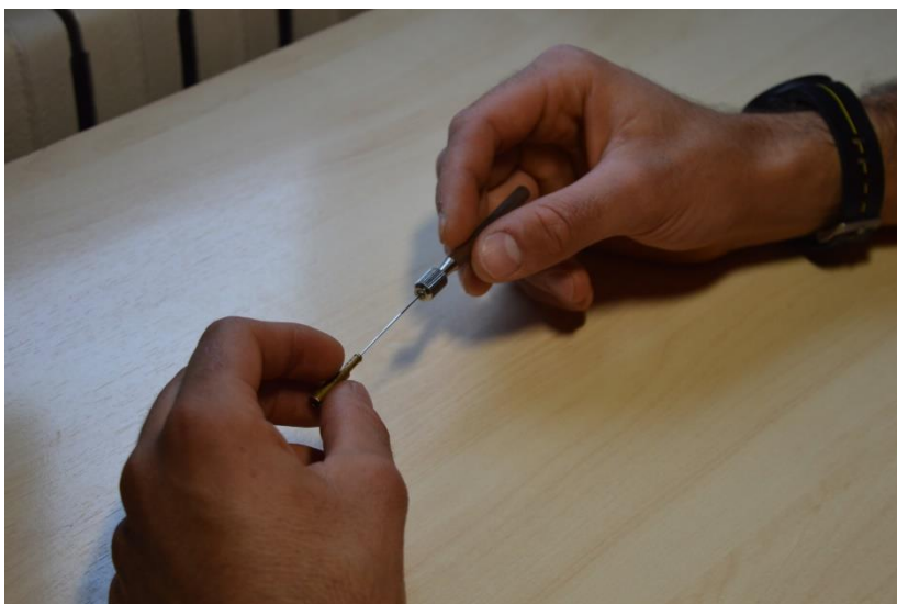
55: Augment del forat d'un gicleur amb un mandril escairador (Font: Foto pròpia)
