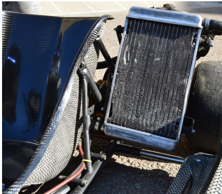
29: Radiador restaurat i netejat (Font: Foto pròpia)
