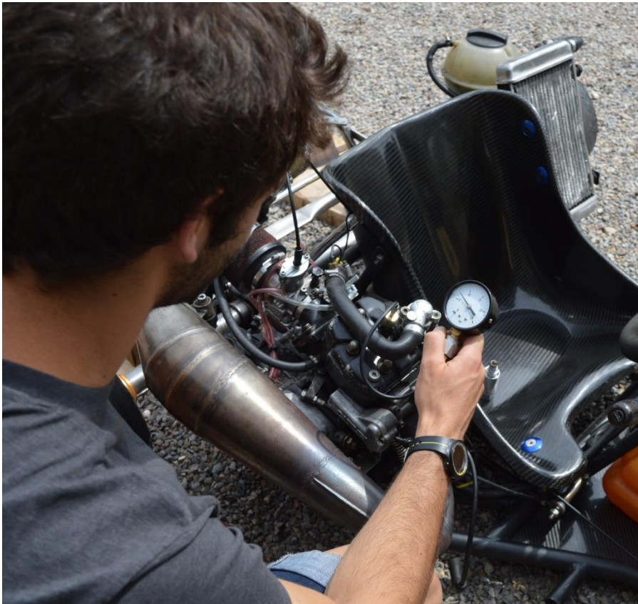
53: Mesura de la compressió del motor (Font: Foto pròpia)
