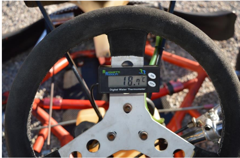
34: Pantalla de temperatura de refrigerant (Font: Foto pròpia)
