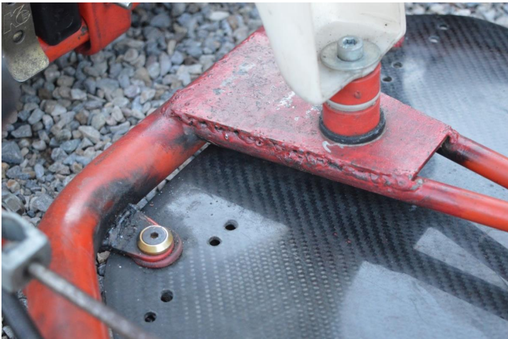
17: Soldadura part davantera kart (Font: Foto pròpia)
