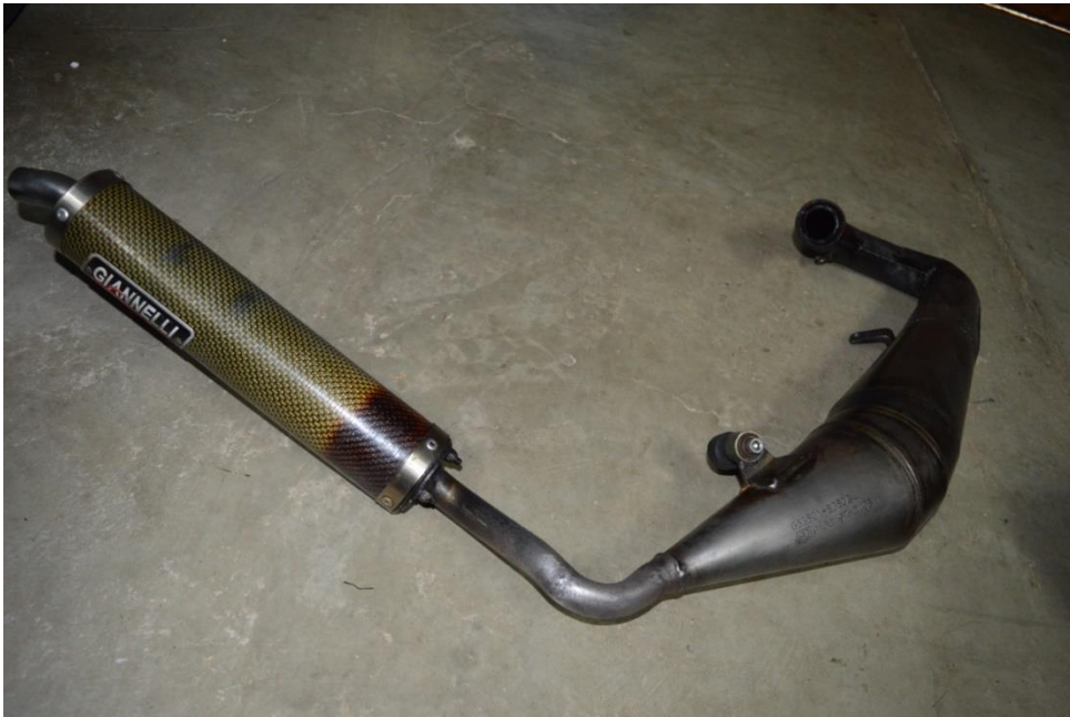
26: Tub d'escapament acabat i polit (Font: Foto pròpia)
