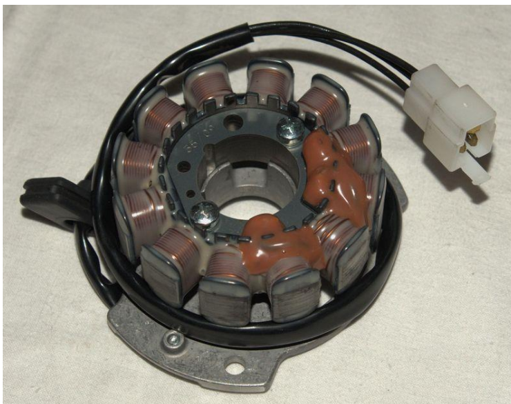
14: Estator d'un motor de 2 temps (Font: www.powerdynamo.biz )
