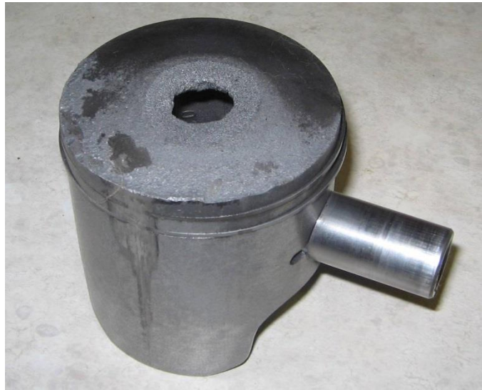
52: Efectes de la detonació en cas extrem en el pistó (Font: www.snowridermag.com )
