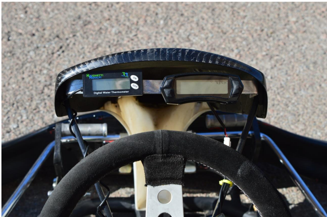
40: Suport de pantalles digitals (Font: Foto pròpia)
