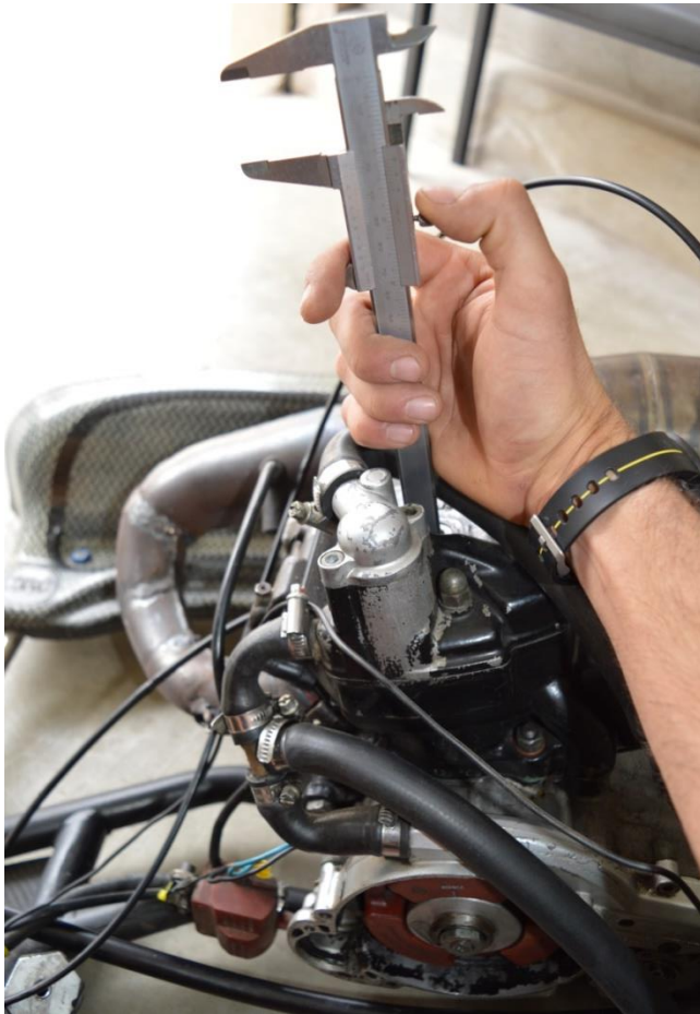
59: Mesura de la posició del pistó en el moment d'encesa (Font: Foto pròpia)
