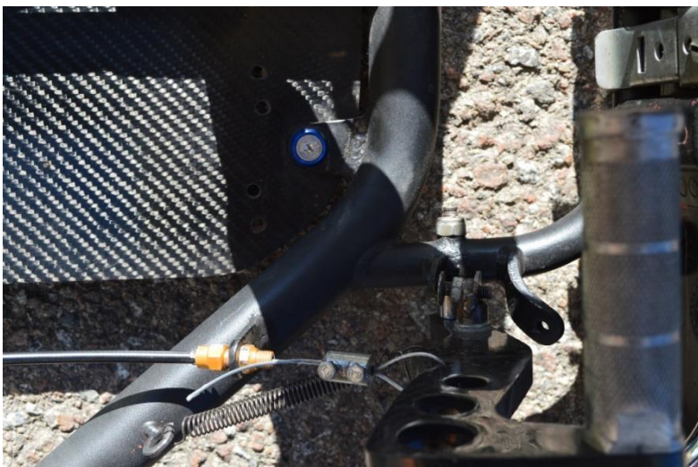
30: Modificació en el sistema de l'accelerador (Font: Foto pròpia)
