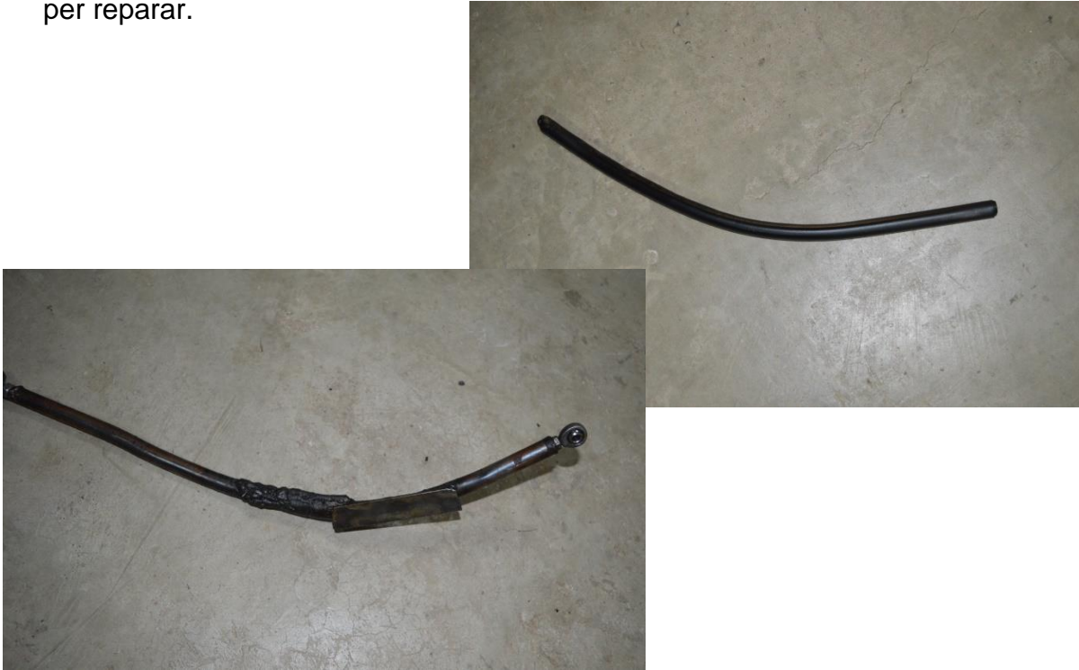
22: Vareta del canvi de marxes antiga a l'esquerra i nova fabricada des de zero a la dreta (Font: Foto pròpia)
