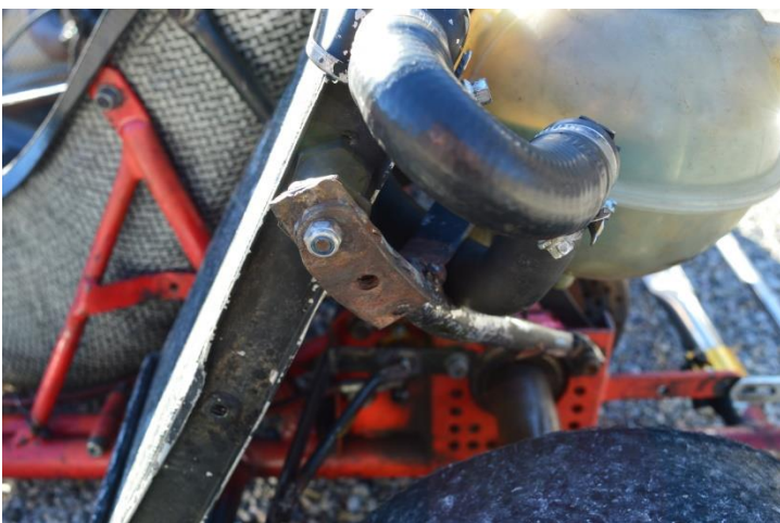
20: Suport del radiador antic, amb risc per les persones que el manipulen (Font: Foto pròpia)
