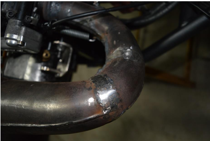
25: Tub d'escapament reparat per un professional (Font: Foto pròpia)
