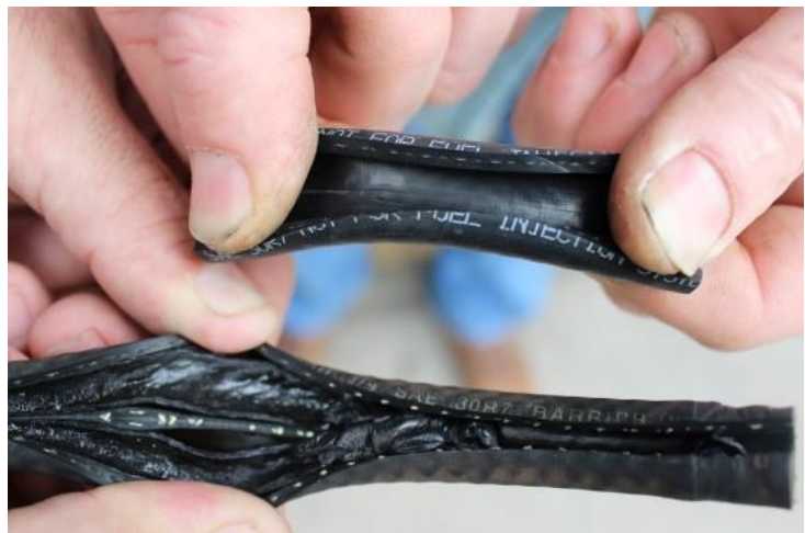
51: Danys produïts pels efectes de l'etanol en un tub de goma (Font:www.thetruthaboutcars.com)
