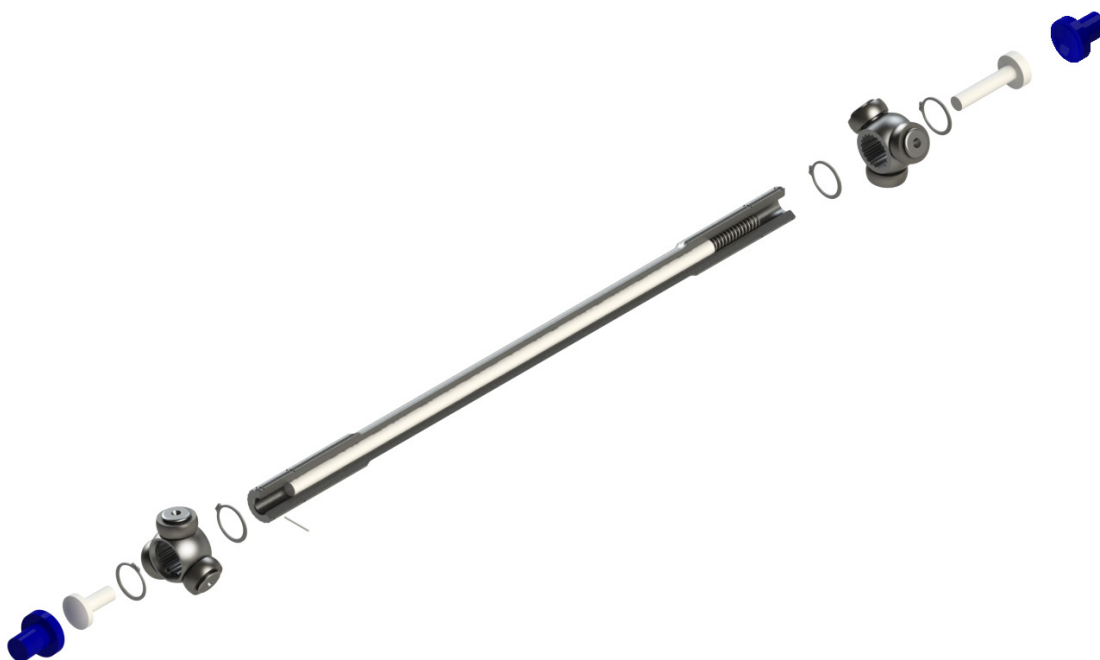
Figura 8.23 – Vista explosionada del conjunt palier, amb vista de secció del propi palier
