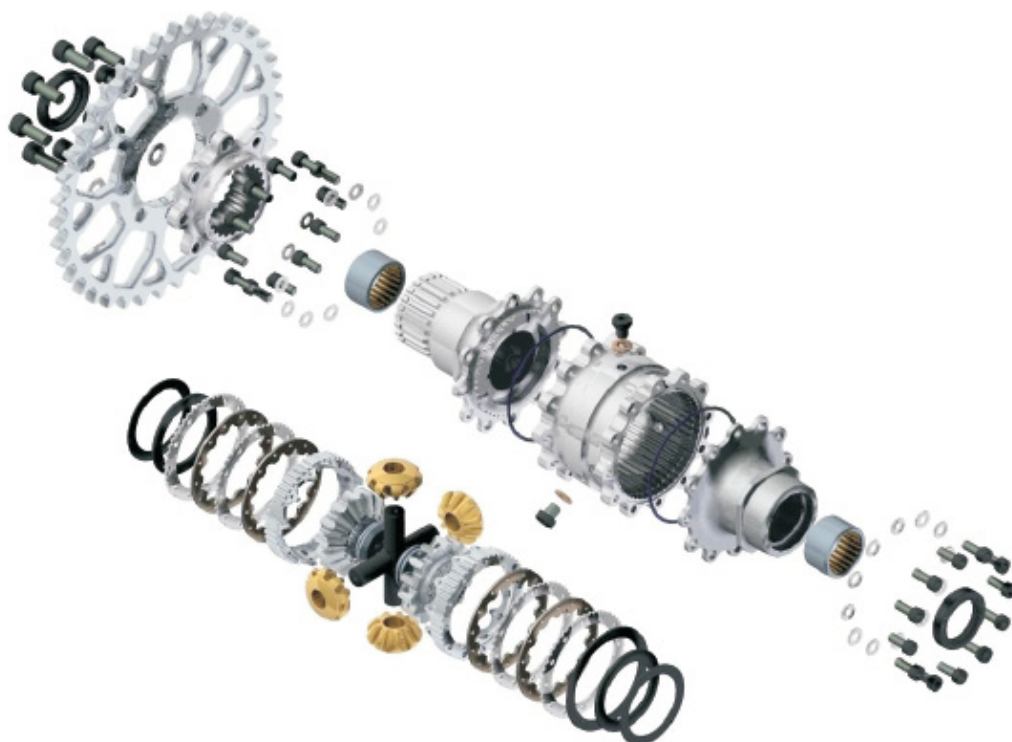
Figura 8.21 – Explosionat d'un diferencial autoblocant de tipus Salisbury. A la part superior peces corresponents a la carcassa exterior i acoblament amb una corona per transmissió per cadena. A la part inferior components del mecanisme interior del diferencial: engranatges cònics, rampes i discos de fricció.
