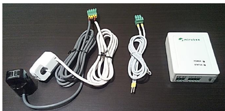
Figura 31. Aspecto real del monitor de energía y sus tres sensores. (MiRubees 2015)
