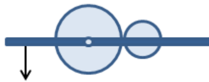
Figura 7.20. Fuerzas que actúan sobre el eje
