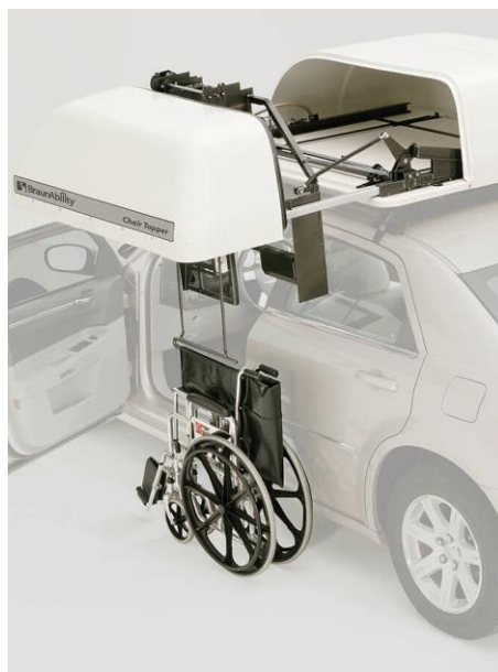
Figura 5.1. Idea de producto a diseñar (ARC-soluciones [2])
