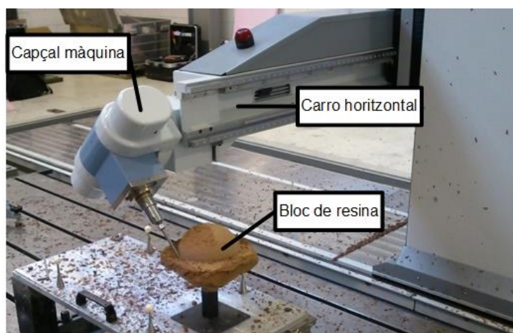
Fig. 5.3. Mecanització de prova una vegada instal·lada la màquina
