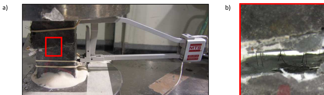
Figura 3.26 Ensayo de pull-out: a) Preparación del ensayo, b) Detalle de la abertura de fisura de una probeta ensayada
