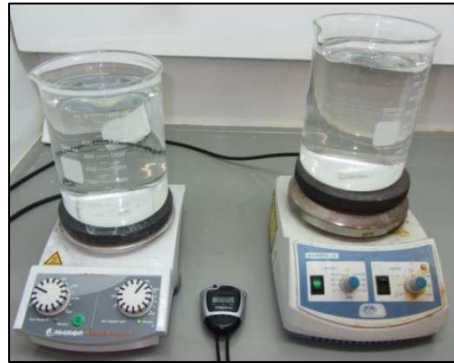
Figura 3.7 Agitación magnética de las disoluciones con TEOS
