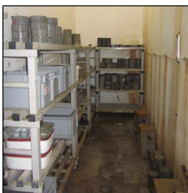
Figura 3.18 Probetas en la cámara húmeda
