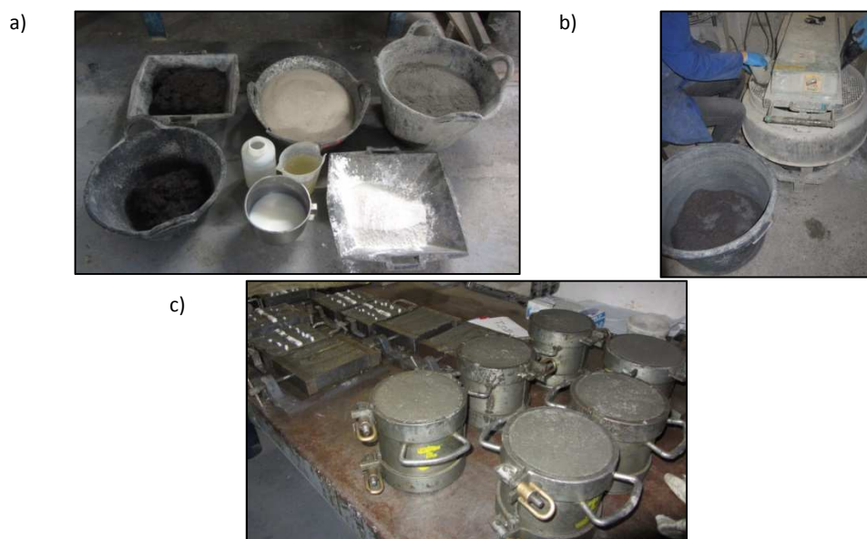
Figura 3.21 Fabricación del hormigón: a) Preparación de los materiales, b) Incorporación de las fibras, c) Probetas
