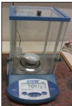
Figura 3. 10 Preparación de la disolución: \text{Ca(OH)}_2 en polvo
