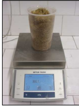
Figura 3.2 Balanza con 300 gramos de fibra sin tratar
