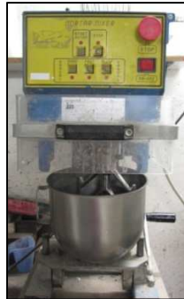
Figura 3. 16 Amasadora de 2l de capacidad
