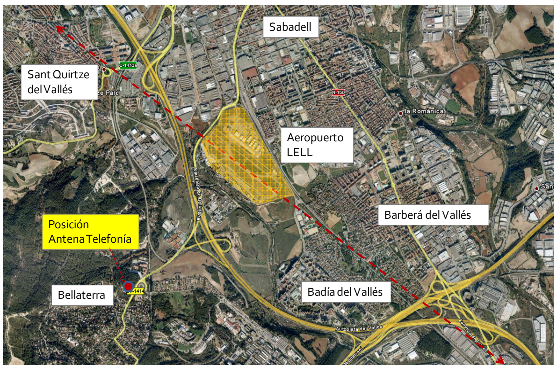
Fig 3 Posición relativa de la antena respecto al eje de la pista de Sabadell
