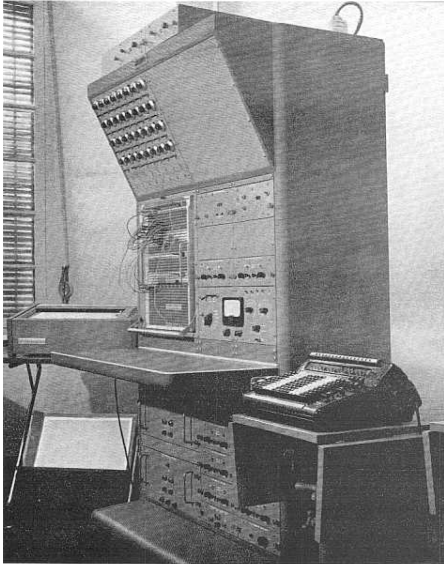
Figura 57. Laboratorio de Cálculo. Calculador analógico PACE 16-31 R (años 1960).
