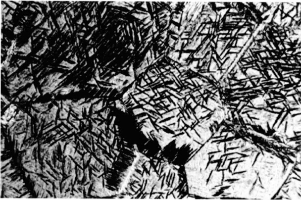
Fig. 5. Estructura martensítica a'. (1050 °C durante 1 hora y temple en agua).
