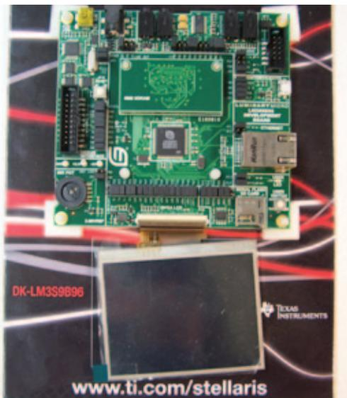
**Figure1: LM3S9B96 Board**
