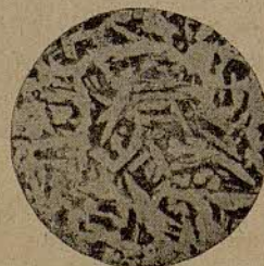
Fig. 9.—Micrografía de un acero templado y recocido a temperatura muy elevada perlita (aumentado \times 100 ).
