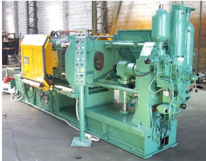
Fig. 4.32 Cámara fría horizontal para fundición a presión de aleaciones no férricas.
