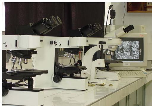
Fig. 8.1 Microscopios metalográficos.
