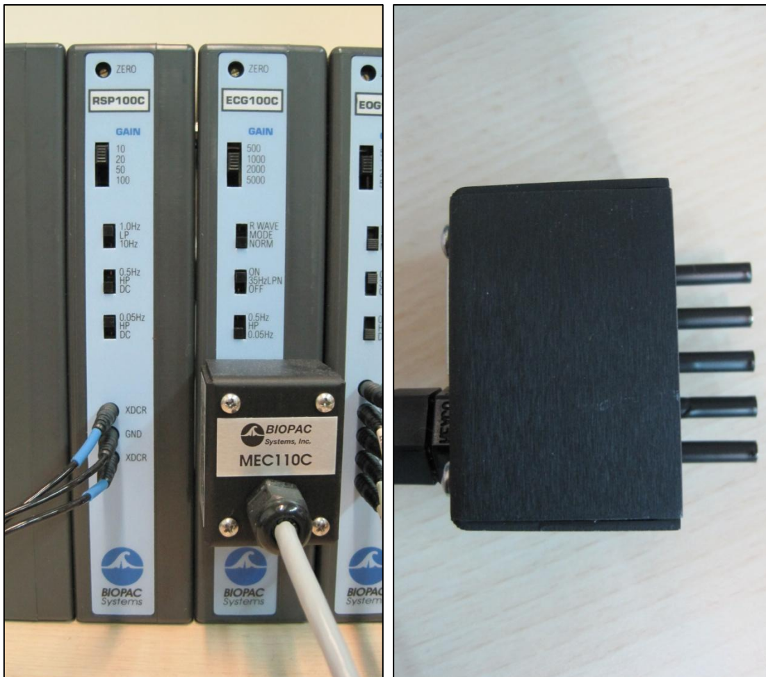
Figura 3.10. A la izquierda, conexión del alargó al módulo ECG. A la derecha, perfil del conector del alargó.
