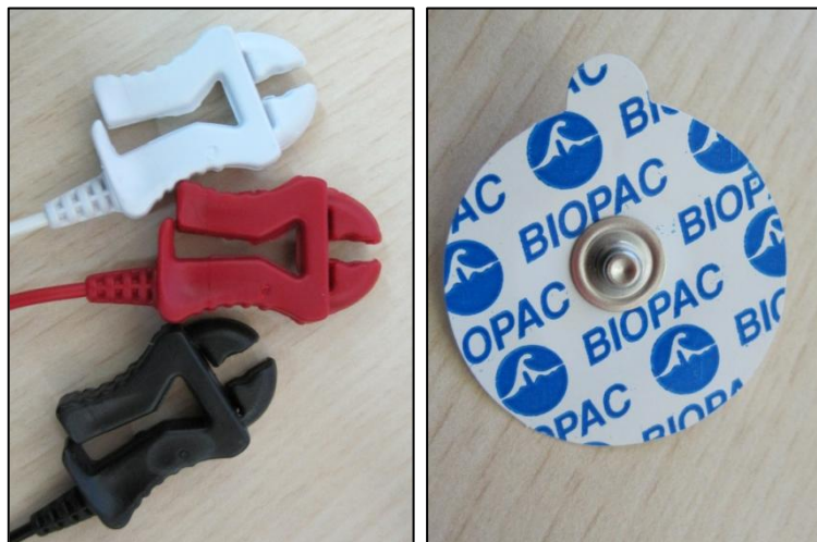
Figura 3.12. Imágenes de las pinzas y el electrodo. Se observa la parte metálica de este.
