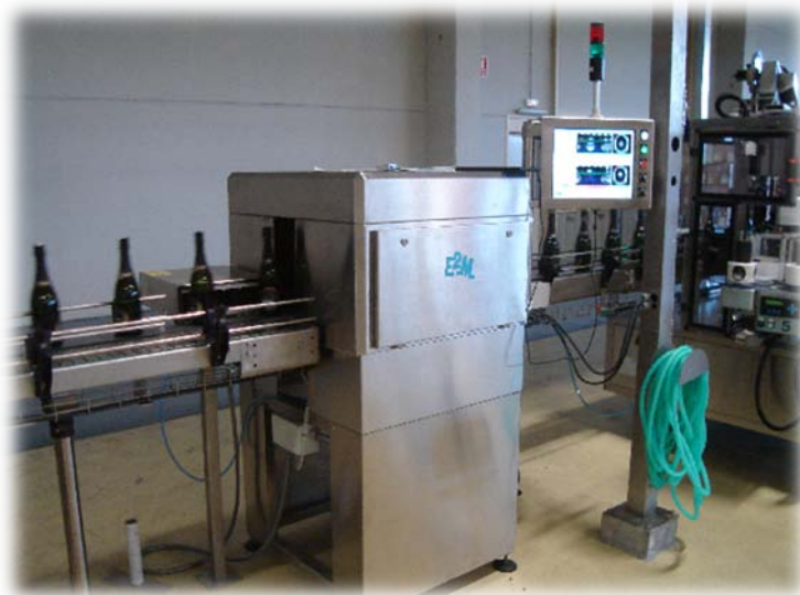
Màquina d'inspecció d'etiquetes d'ampolles, construïda per l'empresa E2M
