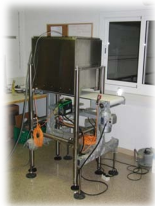
Màquina de proves de l'empresa E2m, on hi va connectat un PC amb l'aplicació VisioInspect2
