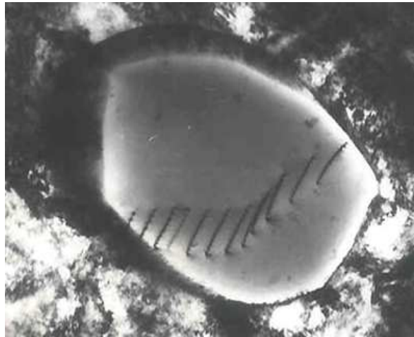
Figura A2.2. Dislocaciones observadas por un TEM
