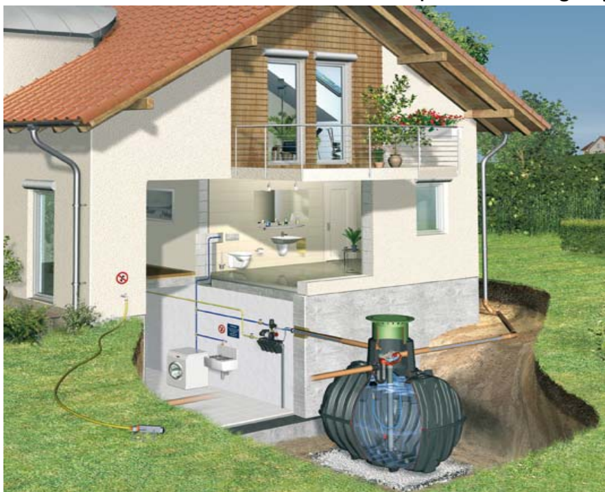
Figura 11. Instalación de recogida de pluviales para usos interiores y riego de jardín en vivienda unifamiliar.
