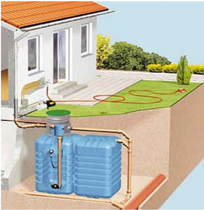
Figura 10. Instalación de recogida de pluviales para riego de jardín.
