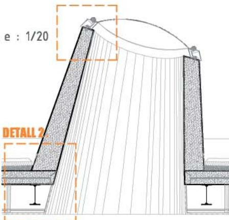
**MUR CONTENCIÓ.** Mur de contenció perimetral realitzat en sistema de dames
