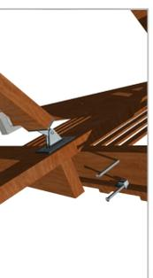
Esta unión no siempre coincide con los pilares con lo cual se pasa una viga longitudinal unida y soportada por todos los pilares a la cual se unió la articulación mediante una plethna metálica y tornillos.
