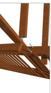
Para la unión entre pilares y vigas que no tienen un encuentro perpendicular se utiliza un tipo de unión articulada en sentido horizontal a modo de bisagra para dar libertad al movimiento.
