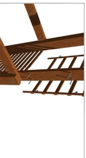
Doble pilar de madera laminada unidos entre sí con pernos con tuercas en su parte inferior para mayor estabilidad del doble pilar. A su vez sirven para el soporte de los paneles de madera los cuales se cueñgan con unos perfiles en forma de "Y" y a continuación se fijan a los pilares con clavos.
