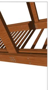
Unión entre viga y doble pilar con 9 pernos de dimensiones varios, dependiendo de la sección de la viga a sujetar, formando una unión empotrada
