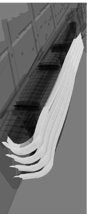
1.-chapa de cobre laminado con doble engatillado con e: 0,7 mm unidas mediante patillas de anclaje al soporte
