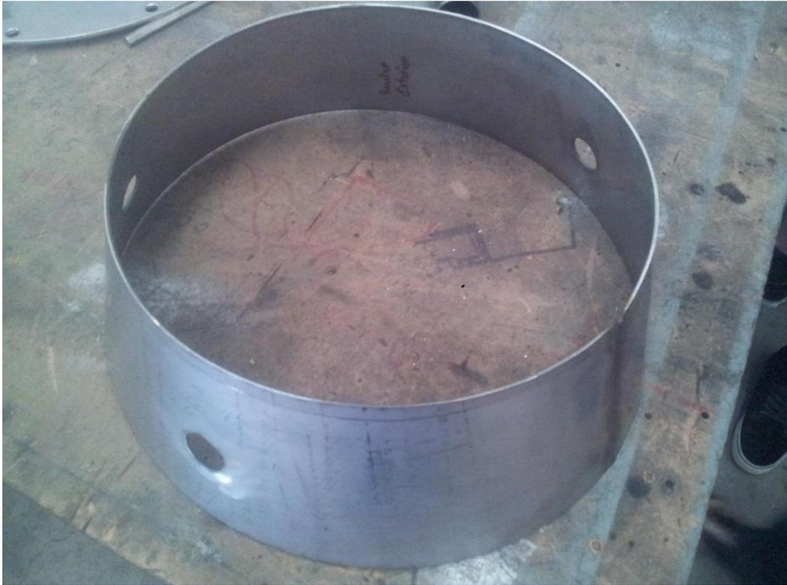
18. Parte superior de la cubierta exterior (capa 2)
