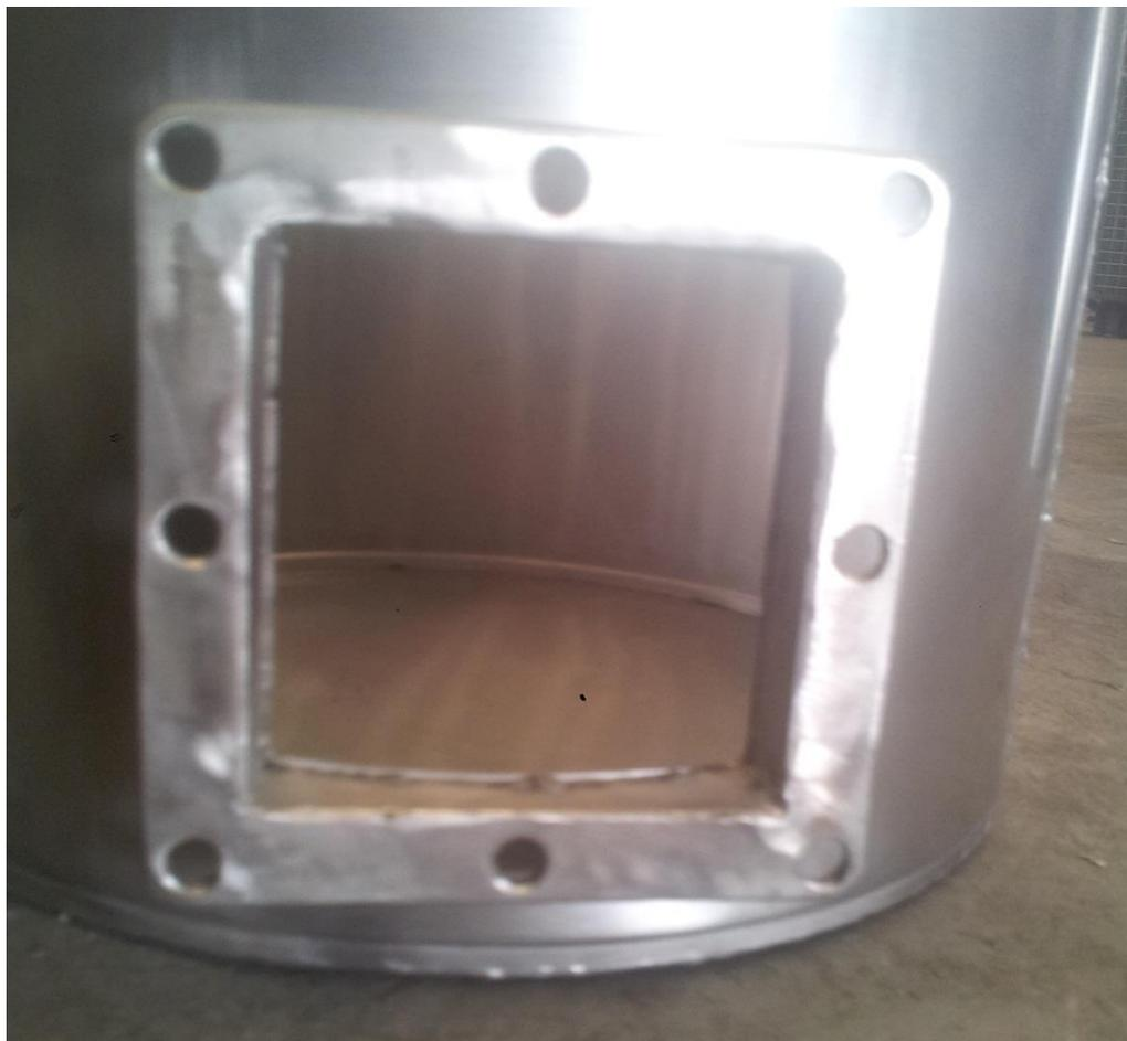
**9. Orificio 2: retirada de las cenizas**
