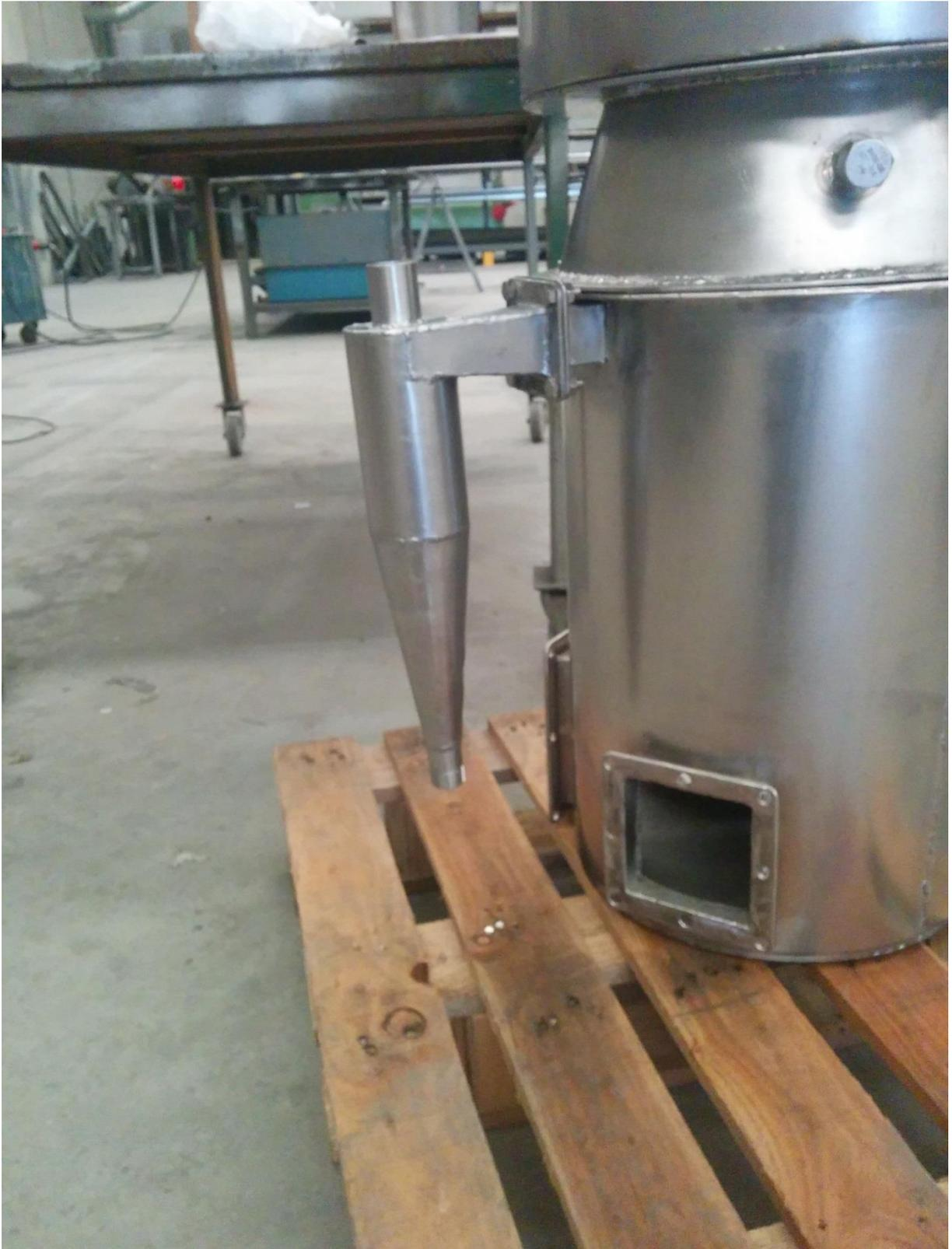
26. Ensamblaje del Ciclón y el Reactor (imagen 2)
