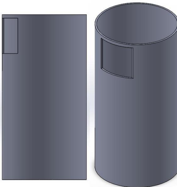
**Figura 27:** Parte cilíndrica del ciclón. (Fuente propia)
