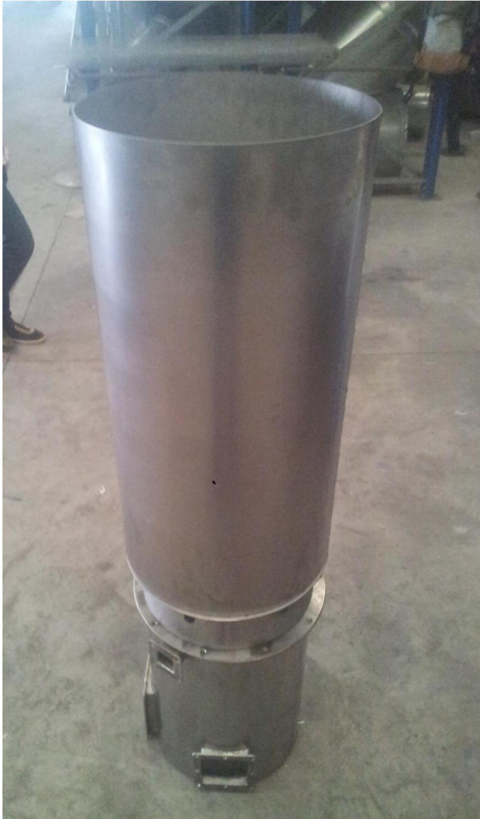
**25.            Ensamblaje del Ciclón y el Reactor (imagen 1)**
