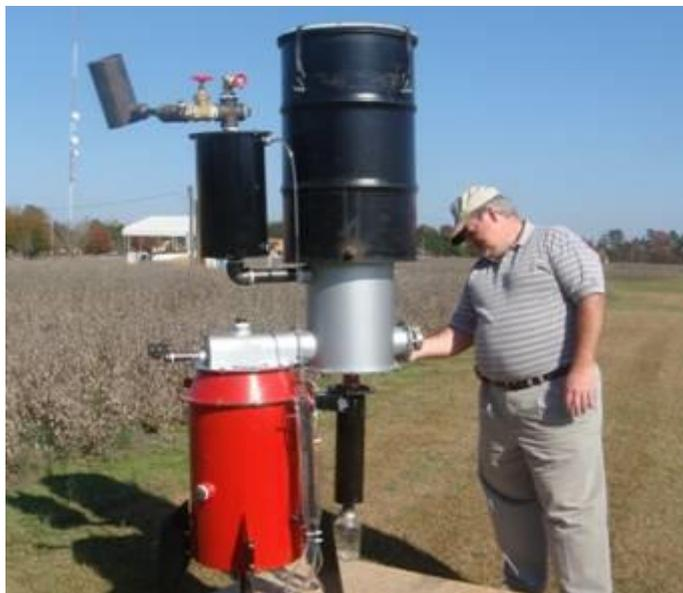
**Figura 18:** Gasificador con tornillo sin fin incorporado (All Power Labs)
