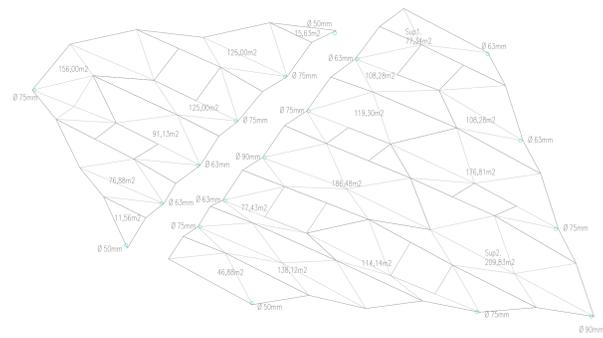
trazado de desagüe en cubierta
