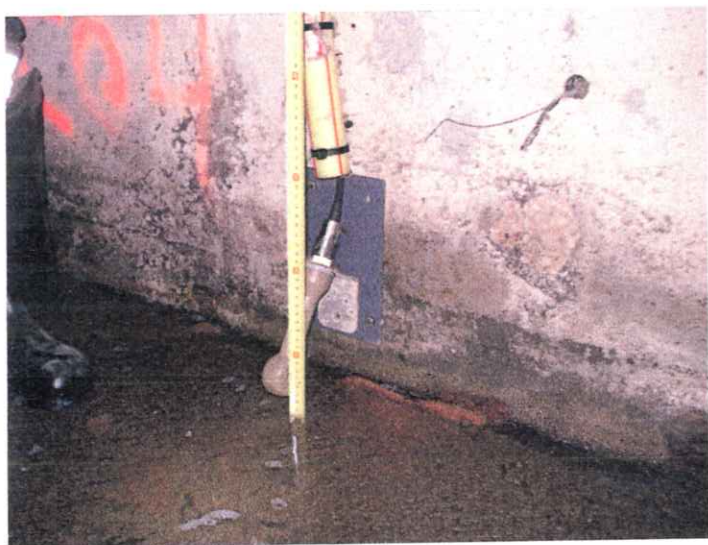
Foto-③ - CO4 medición desde sonda a la parte de abajo del sensor 4,5cm y AL AGUJERO DEL SENSOR 7cm.
