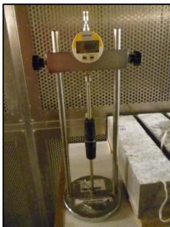
Figura 25. Dispositivo comparador para la variación de longitud; a) barra de control (izquierda), b) lectura de una probeta (derecha)
