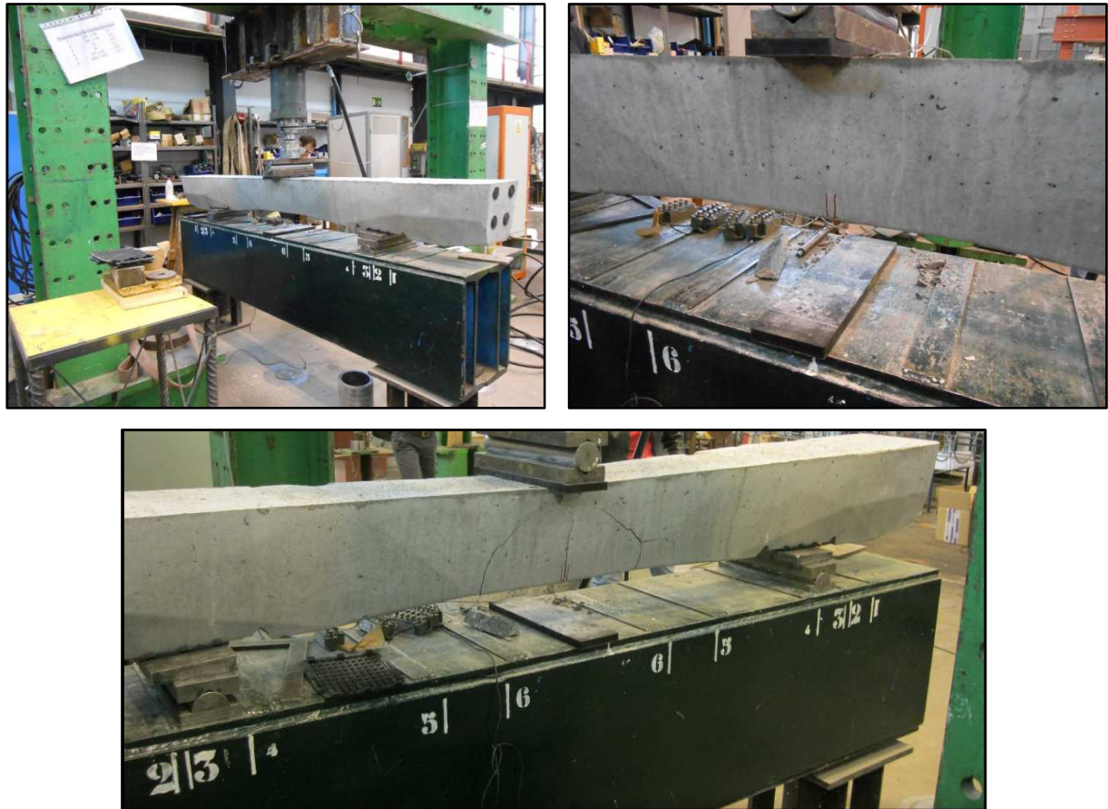
Figura 35. Fotografías del ensayo a flexión negativa en sección central; a) Traviesa ensayada, b) Aparición de la primera fisura, c) Aparición de fisuras por esfuerzo cortante
