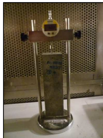
Figura 25. Dispositivo comparador para la variación de longitud; a) barra de control (izquierda), b) lectura de una probeta (derecha)
