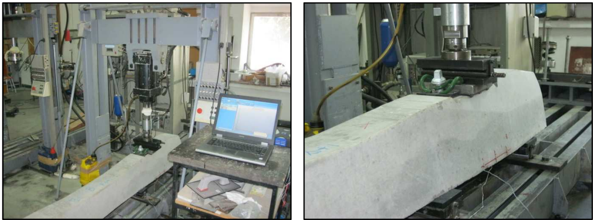
Figura 44. Fotografías del ensayo de fatiga en sección bajo carril; a) Vista general del ensayo, b) Colocación de la galga en la superficie del hormigón
