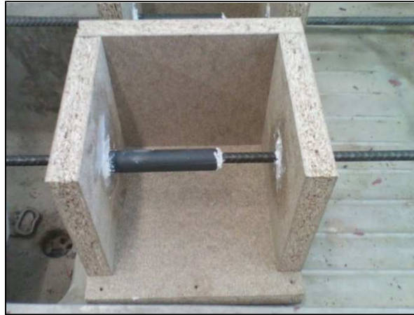
Figura 23. Montaje del molde para el ensayo de arrancamiento (pull-out)
