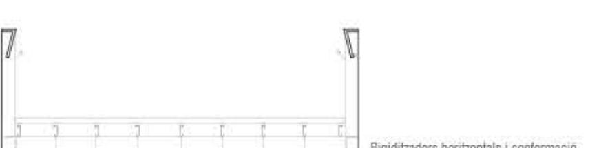
Rigiditzadors horizontals i conformació de la base del sòl
